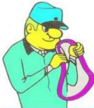
Pemeriksaan keretakan V Belt
