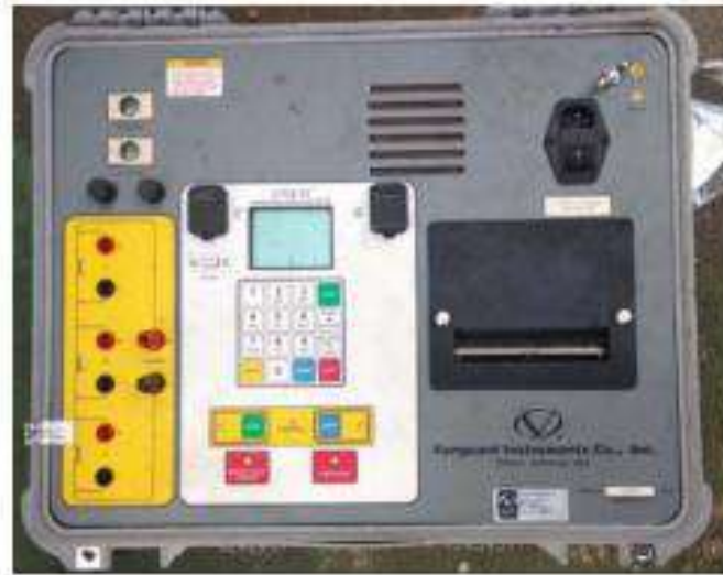
Alat uji belitan transfrmator
