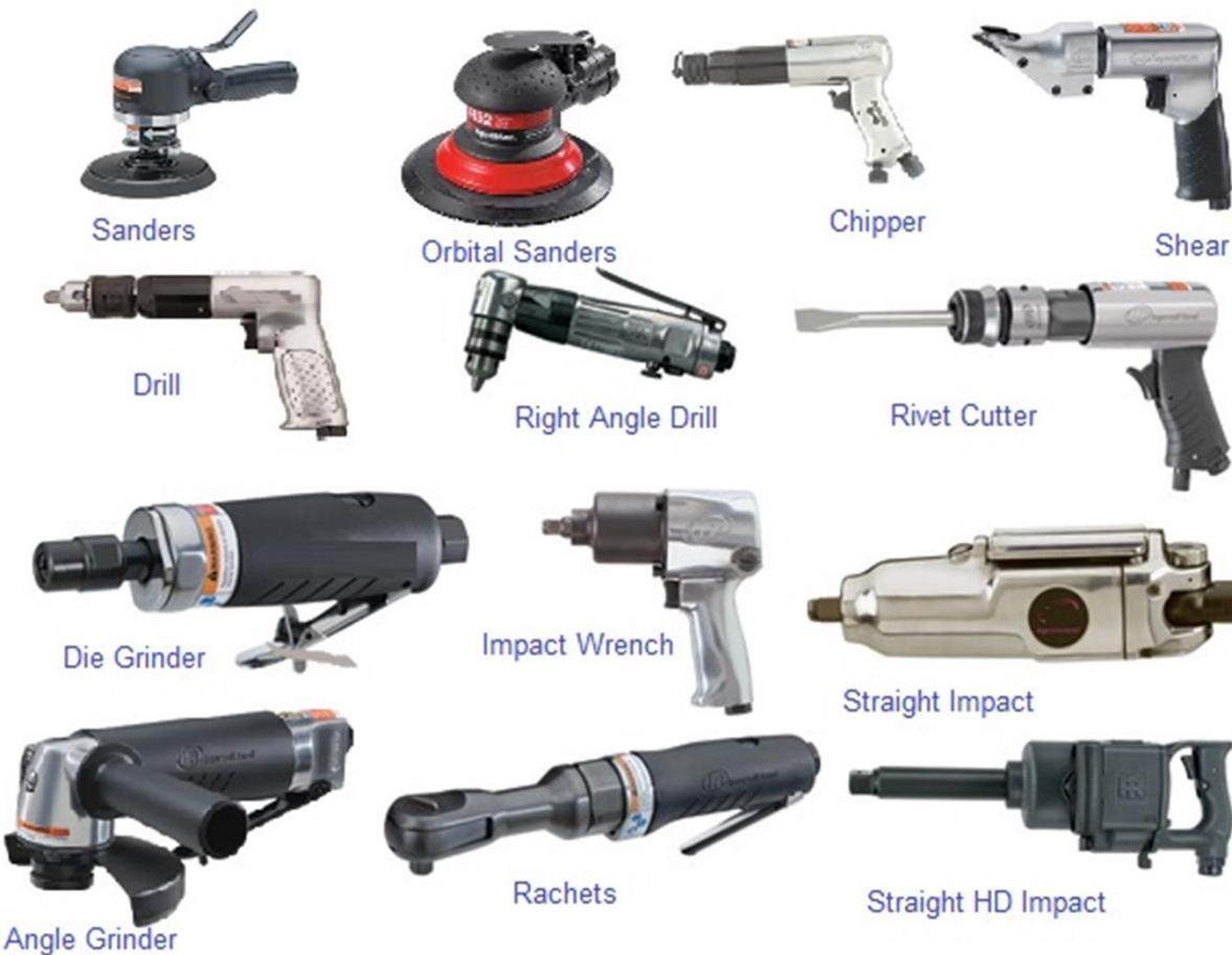
**Pneumatic Tools** merupakan sebuah sistem yang bersumber dari angin yang disimpan untuk mengasilkan suatu kerja yang biasa disebut dengan sistem pneumatic.
